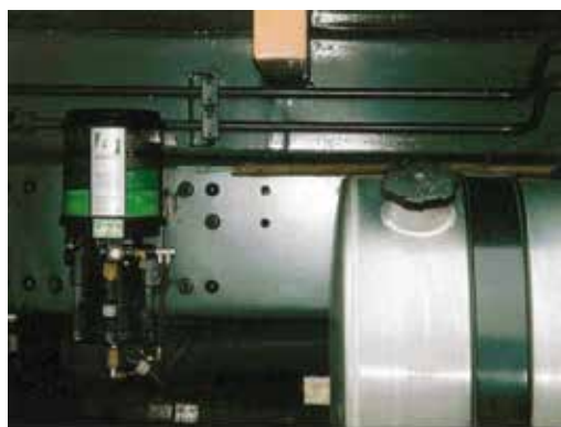
При использовании ЦСС смазка поступает в нужную точку минимальными дозами, но через короткие промежутки времени
